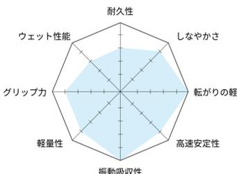
石畳を走破する有名なクラシックレースの名を冠すとおり、エアボリュームを稼いでオンロードでも荒れた路面の走行を想定したチューブラーモデル。ストラダと同様のトレッドパターンと耐パンク性の高い PPS2 を採用したオールコンディション仕様で、27mm 幅なのでロードレーサーへの着用を可能にします。320TPI のコスパコットンには UCI ワールドツアーのオンロードレースでもハイグレードタイヤとして広く認知されている高性能ケーシングです。
